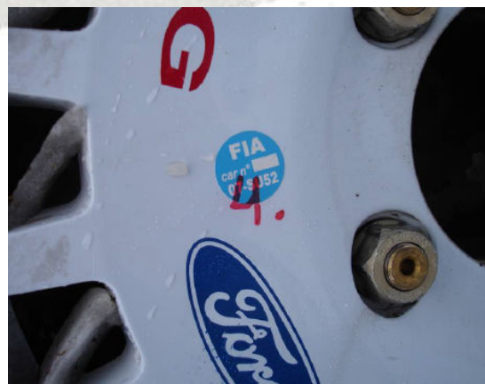
Εικόνα 61: Μαρκάρισμα ελαστικών με ειδικό αυτοκόλλητο FIA
