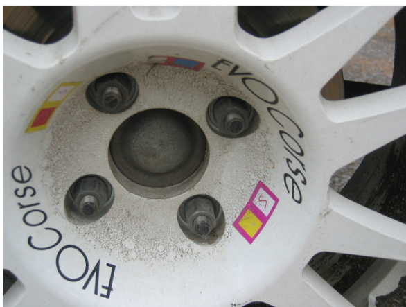
Εικόνα 54: Μαρκάρισμα ελαστικών με ειδικό αυτοκόλλητο
