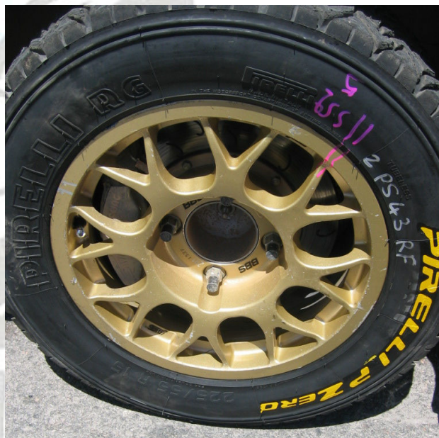
Εικόνα 55: Μαρκάρισμα ελαστικών με μαρκαδόρο
