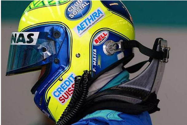
Εικόνα 77: Frontal Head Restraint (FHR)
