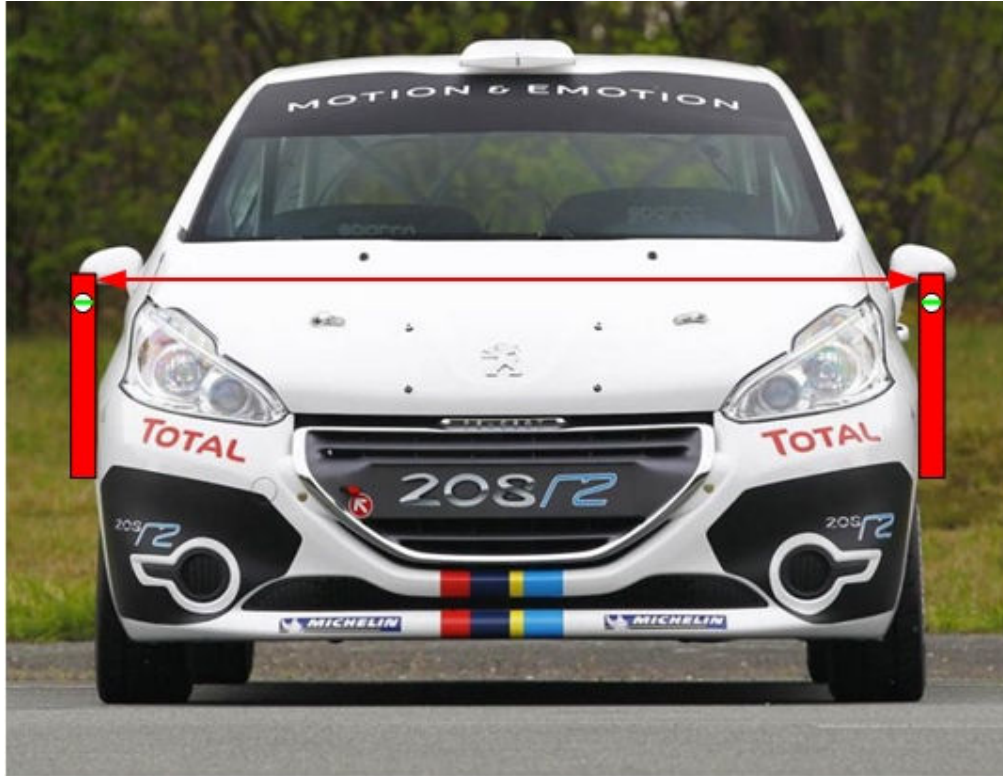
Εικόνα 52: Μέτρηση πλάτους αμαξώματος
