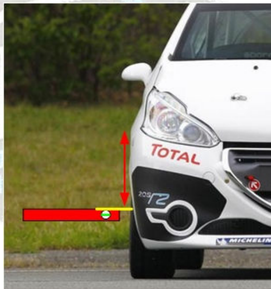
Εικόνα 51: Μέτρηση ύψους ανάρτησης
