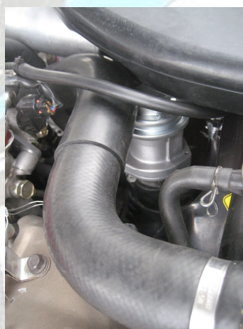
Εικόνα 70: Λανθασμένη τοποθέτηση βαλβίδας bypass Evo IX
