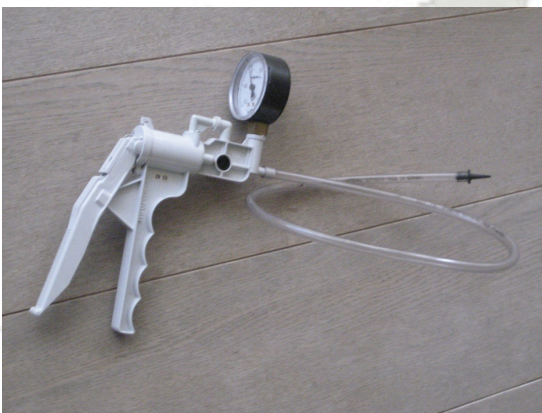
Εικόνα 19: Τρόμπα πίεσης για turbo waste gate
