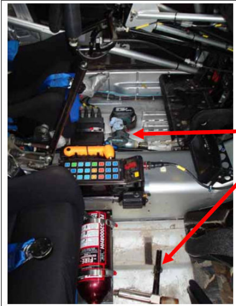
Εικόνα 40: Λανθασμένη τοποθέτηση εργαλείων μπροστά από το πλήρωμα
