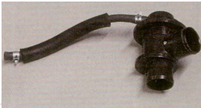
Εικόνα 68: Βαλβίδα bypass Evo VIII και παλαιότερου
