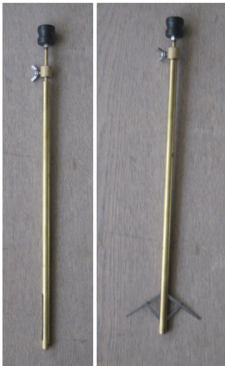
Εικόνα 25: Όργανο μέτρησης διαμέτρου κυλίνδρου
