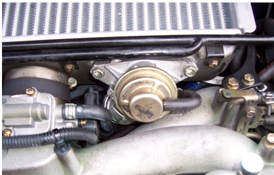
Εικόνα 67: Βαλβίδα bypass Subaru
