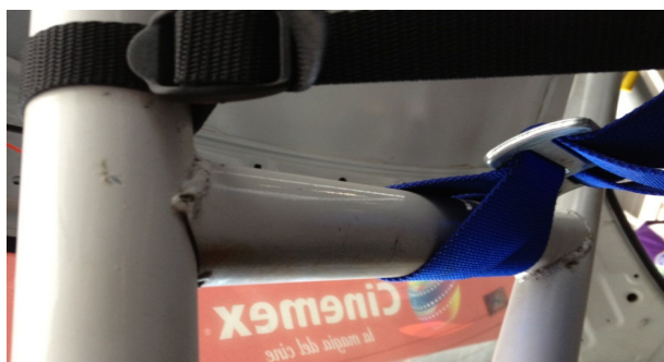
Εικόνα 29: Λανθασμένη κόλληση σωλήνας στήριξης ζωνών ασφαλείας
