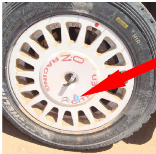
Εικόνα 61: Λάθος μαρκάρισμα πάνω σε αφαιρούμενο πλαστικό προστατευτικό
