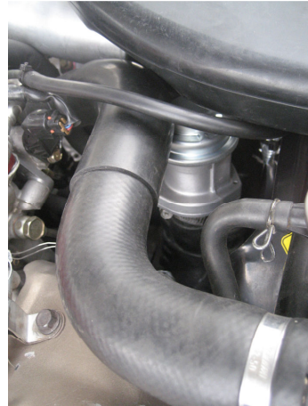
Εικόνα 75: Λανθασμένη τοποθέτηση βαλβίδας bypass Evo IX
