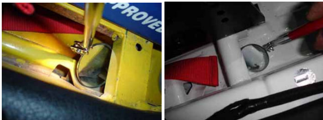
Εικόνα 36: Λανθασμένες κολλήσεις βάσεων καθισμάτων
