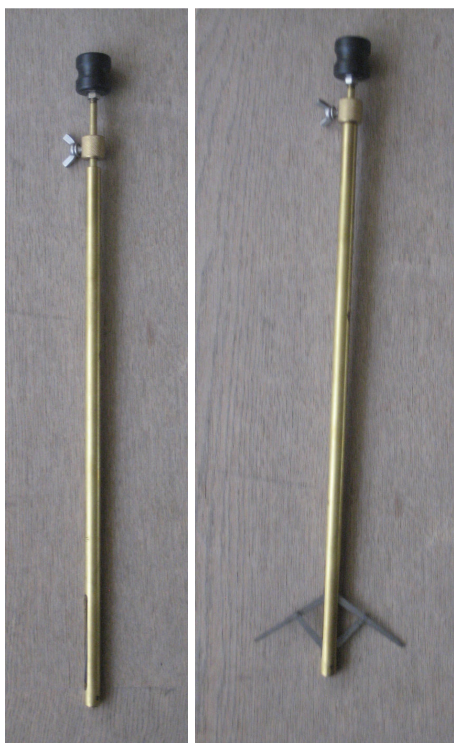
Εικόνα 25: Όργανο μέτρησης διαμέτρου κυλίνδρου
