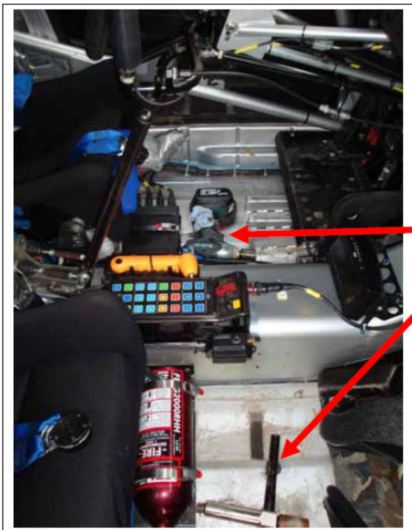
Εικόνα 42: Λανθασμένη τοποθέτηση εργαλείων μπροστά από το πλήρωμα
