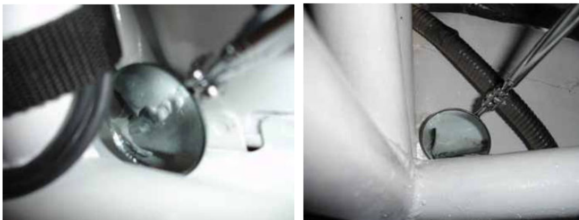
Εικόνα 28: Λανθασμένες κολλήσεις κλωβού ασφαλείας
