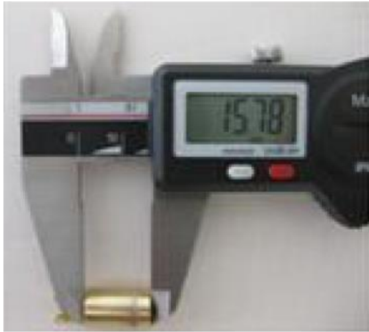
Atomizer διάσταση της τομής 5,8 + / - 0,3 mm
